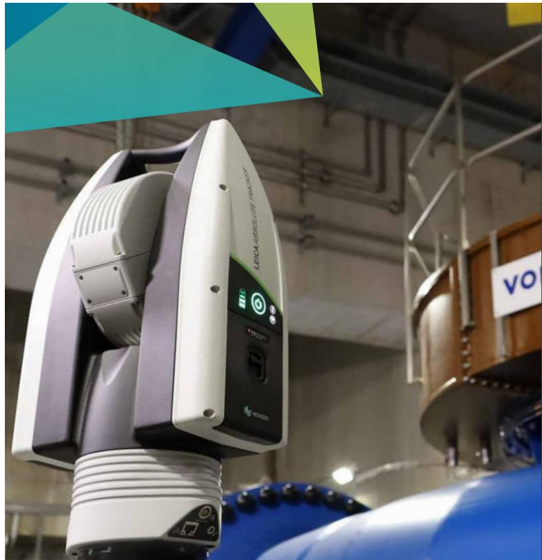
Рисунок 2 - Загальний вигляд абсолютного трекера Leica AT500
