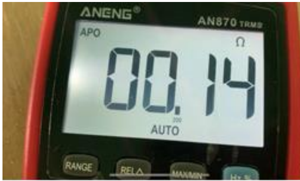
Фото 3. Вимірювання активного опору в котушці індуктивності
